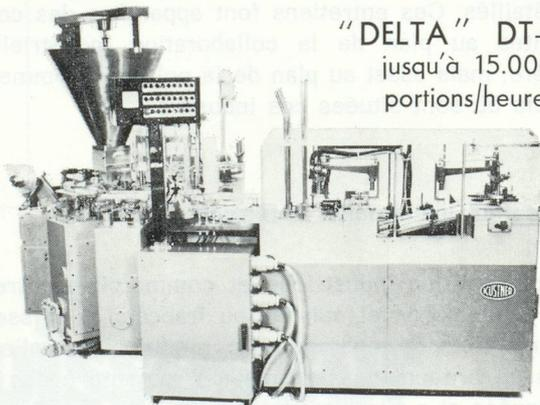
Machines automatiques pour la préparation et l'emballage du fromage fondu. Mouleuses, emballeuses automatiques pour le beurre, la margarine et autres produits pâteux.
