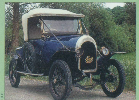
Torpédo deux places Egg de 1919, animée par un moteur 4 cylindres Zurcher à soupapes latérales, carburateur Zénith et exhausteur Orion.
