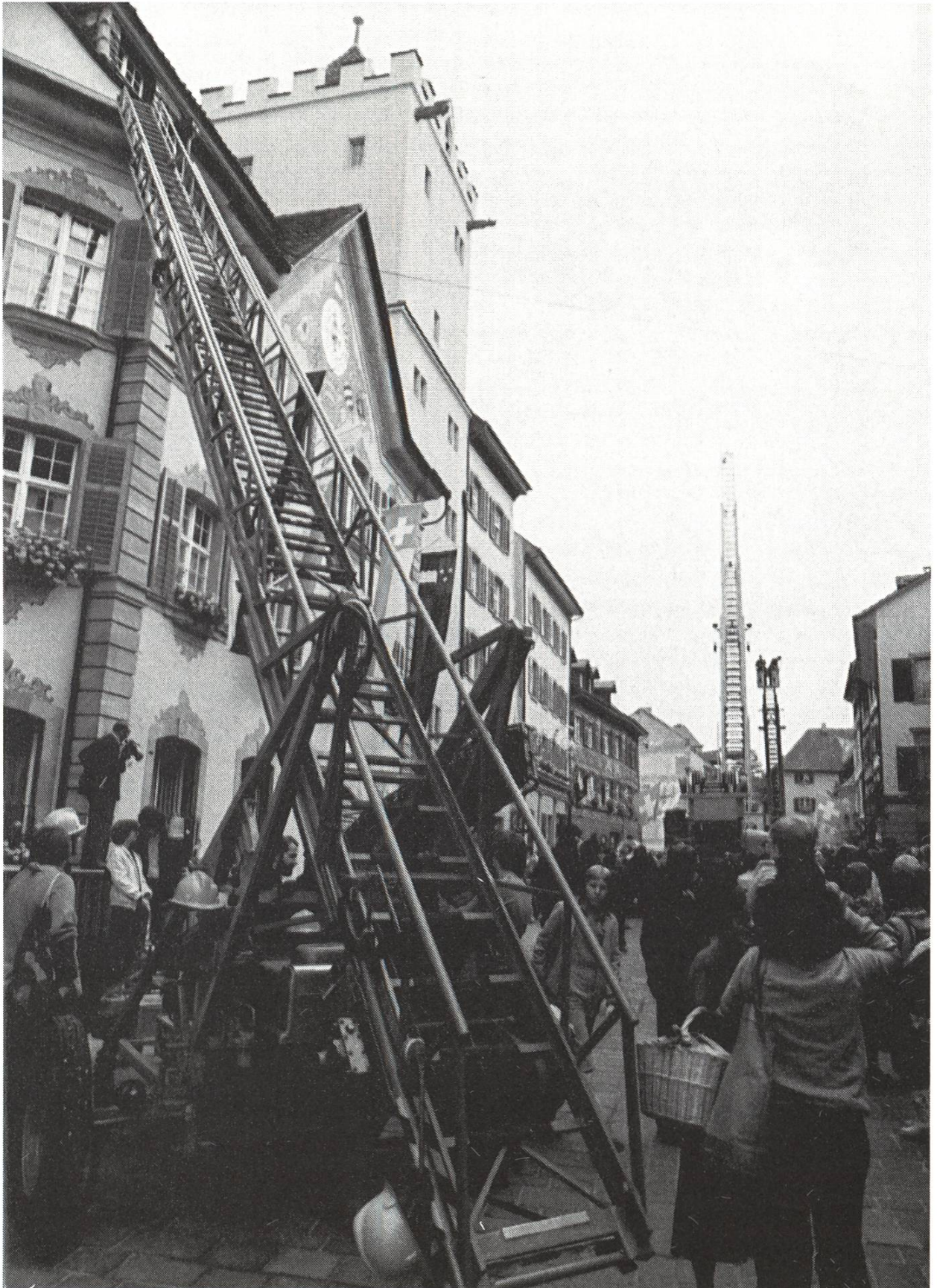
In den 70er Jahren ersetzte die Ehrsam-Anhängerleiter ALN 22 m mit mechanischem Handantrieb die Strebenleiter und die mechanische Drehleiter aus dem Jahre 1929.
