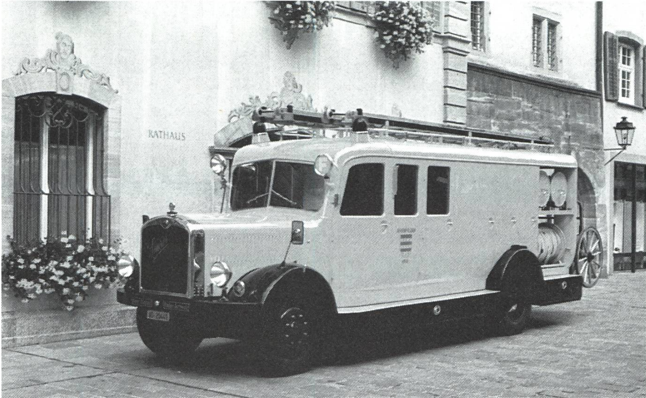
Erstes Feuerlöschfahrzeug der Marke Saurer (T.L.F.), 1938, mit 240 l Tankinhalt, Saug- und Druckpumpe.
