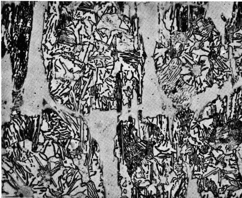
Fig. 45. — Perlite lamellaire grossière. (Grossissement 500 fois.)
