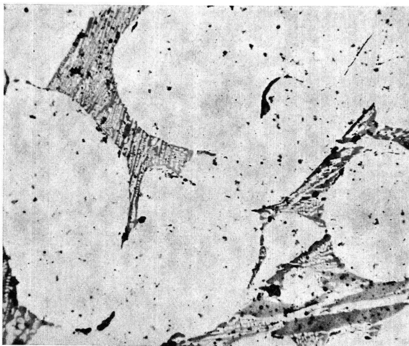
Fig. 41. — Eutectique ternaire des phosphures ; coloré en foncé ; permanganate de potassium. (Grossissement 320 fois.)
