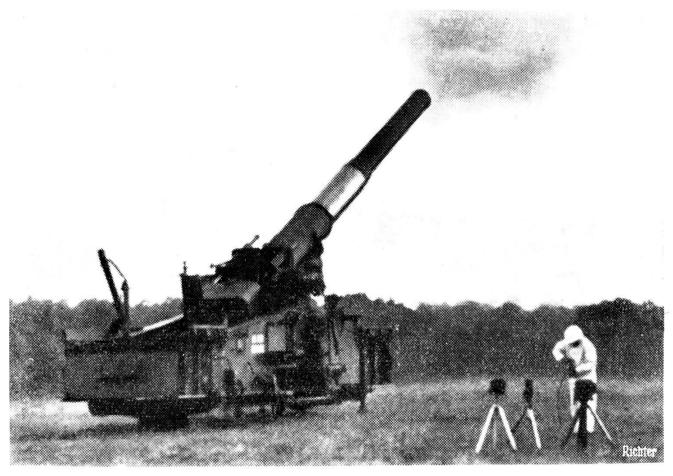
Stati Uniti America. — Questo cannone serve per i proiettili atomici e per quelli ordinari a polvere: cal. 280 mm.; peso 85 ton.; portata ca. 32 km.; viene trainato da due trattori muniti di leve idrauliche per il suo funzionamento. Il tiro viene comandato a mezzo di un'apparecchiatura elettrica.
