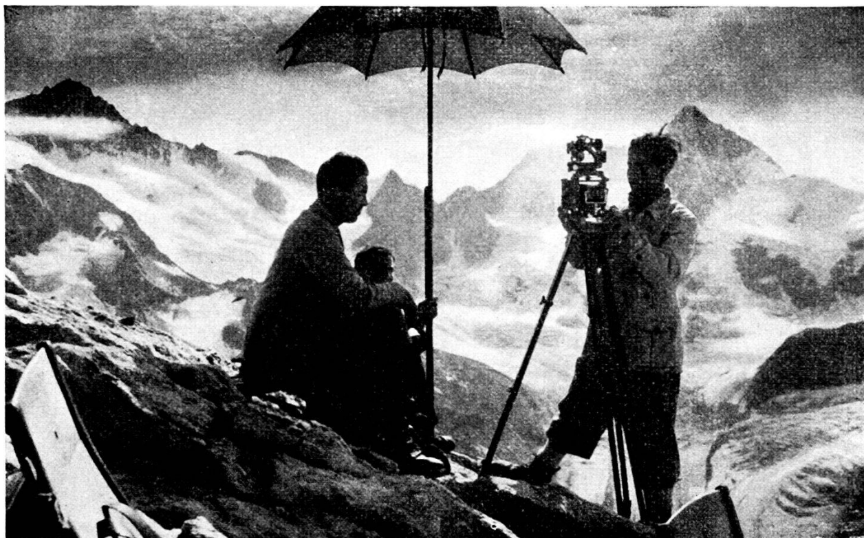
Fig. 1 — Fotogrammetria terrestre : rilievo con il fototeodolite
