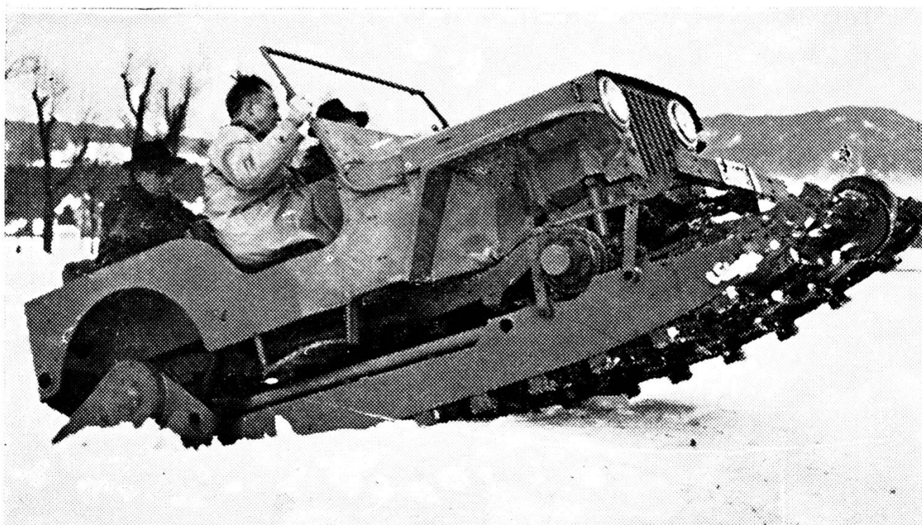
SVIZZERA : Jeep attrezzata per terreno nevoso. Velocità 30 km. orari. Può essere provvista di rimorchio su pattini
