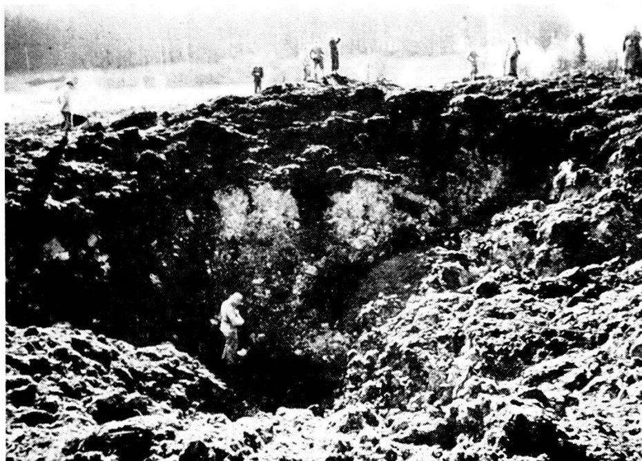
Cratere prodotto dall'esplosione di una carica di 500 kg.
