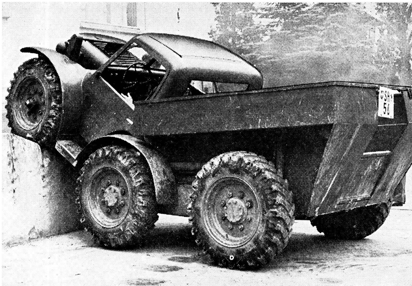
D Il « Metrac 4 » supera un ostacolo. Il segmento anteriore viene sollevato con il congegno idraulico.
