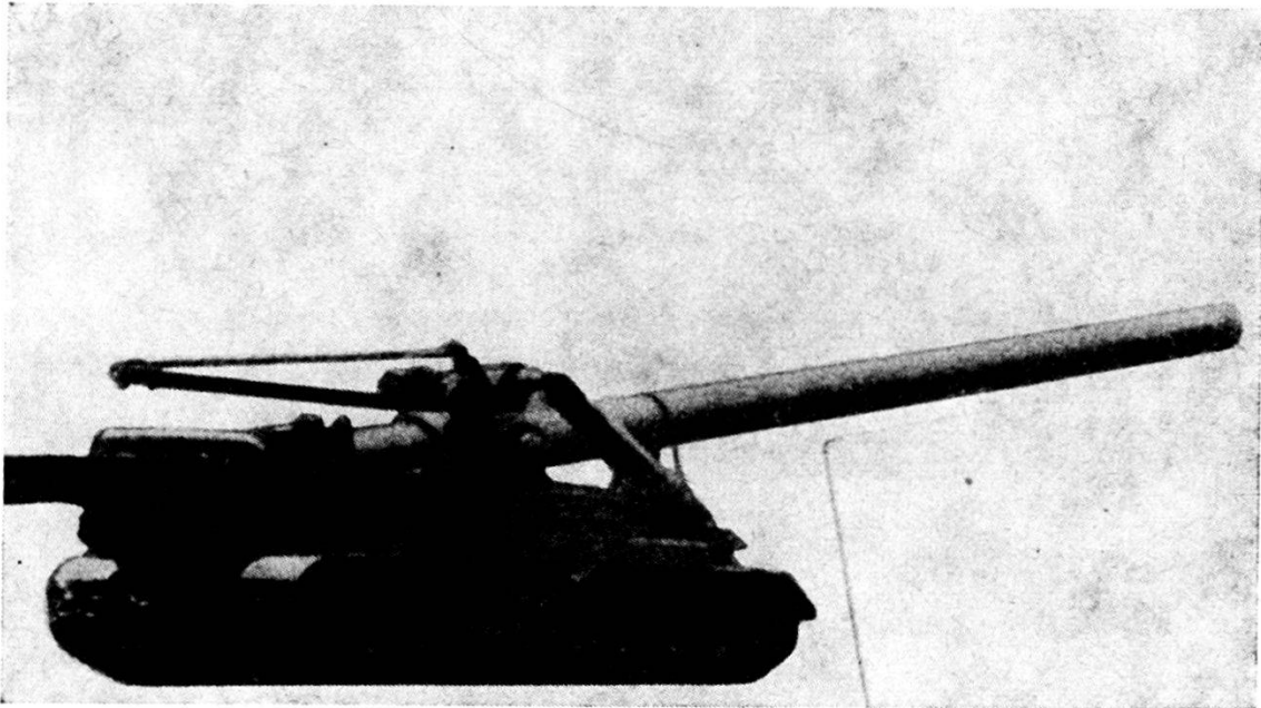
6. URRS: Semoviente per il tiro dei proiettili autopropulsi (razzo tirato), calibro dai 300 ai 400 mm., portata dai 40 ai 60 km.
