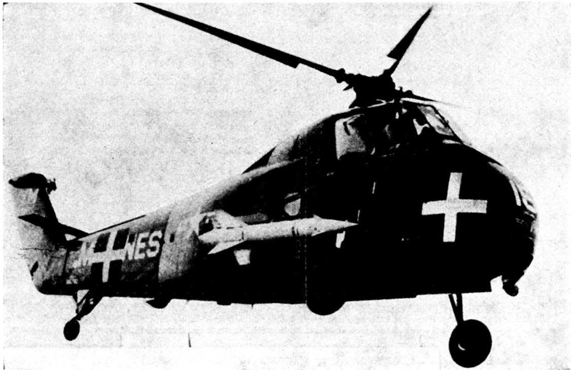
10. USA: Elicottero della Army Aviation, con un missile guidato aria-terra «Bullpup».
