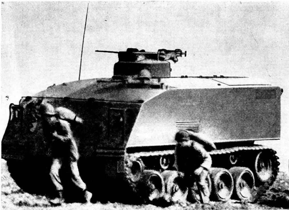
Veicolo di accompagnamento di carri americano M 75 : capienza: 10 uomini in assetto di combattimento, armamento: 1 mitragliatrice pesante, velocità massima su strada: 50 km/h. Questo veicolo è stato usato con successo nella campagna di Corea.
