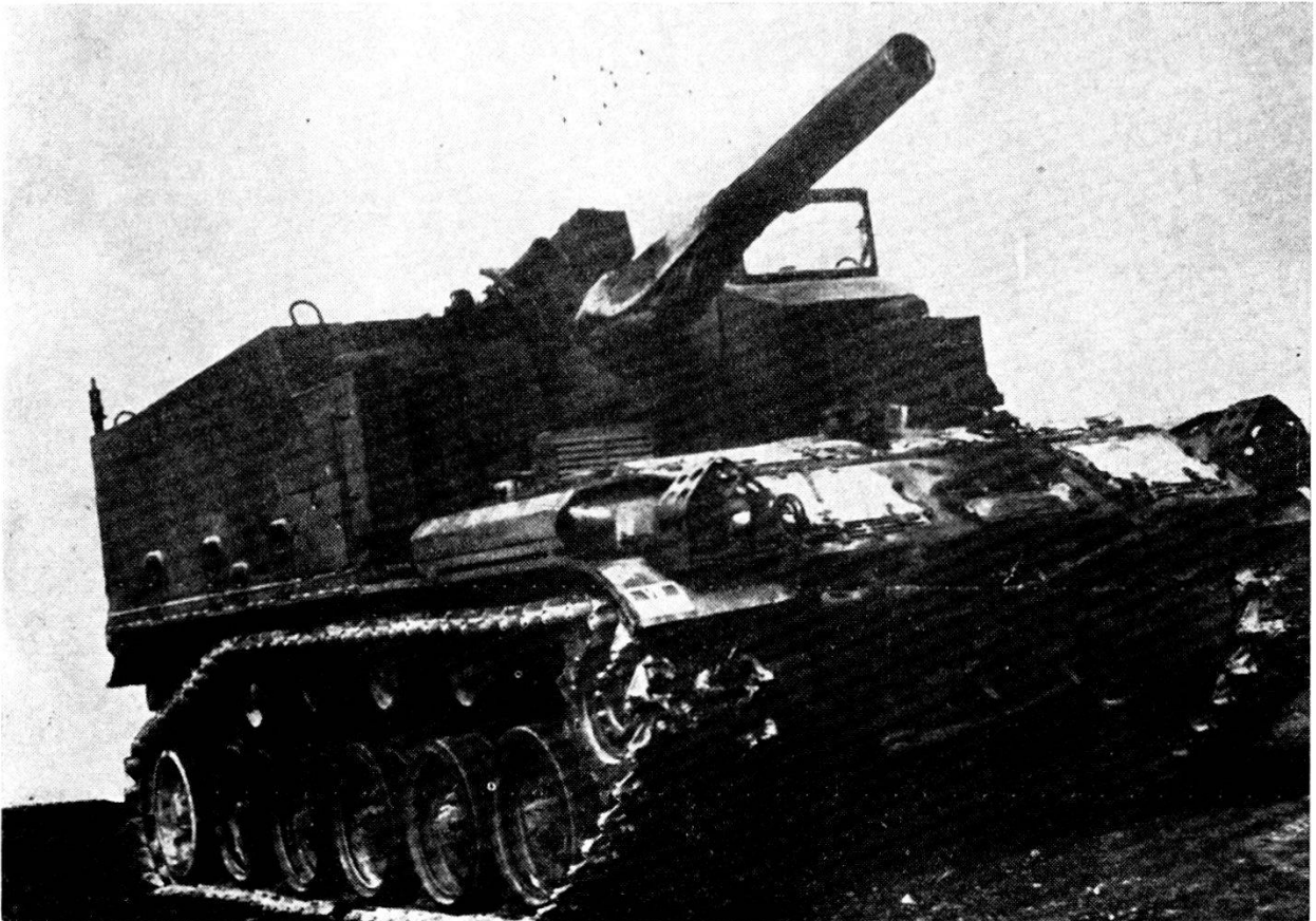
Obice semovente calibro 15,5 cm su scafo M 44 in dotazione a reparti stranieri.
