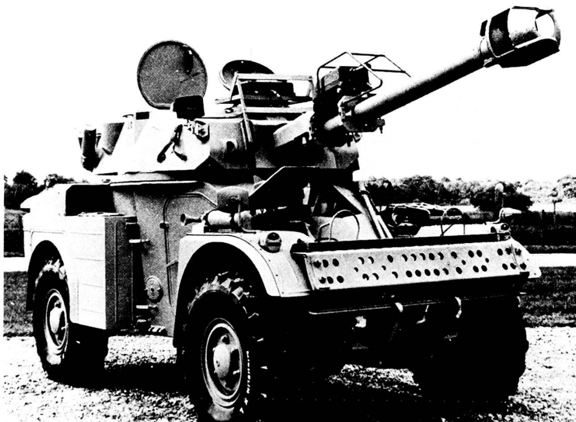
AML 90 (Francia) — È impiegato nelle unità di esplorazione, quale carro di sostegno per i carri leggeri di ricognizione. Carro a 4 ruote, veloce e ben armato.
