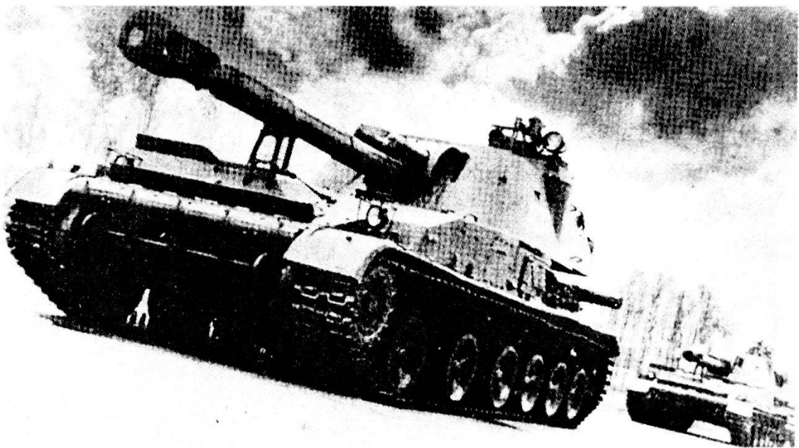
Fig. 12. Obice corazzato calibro 152 mm (SP 73) semovente.
