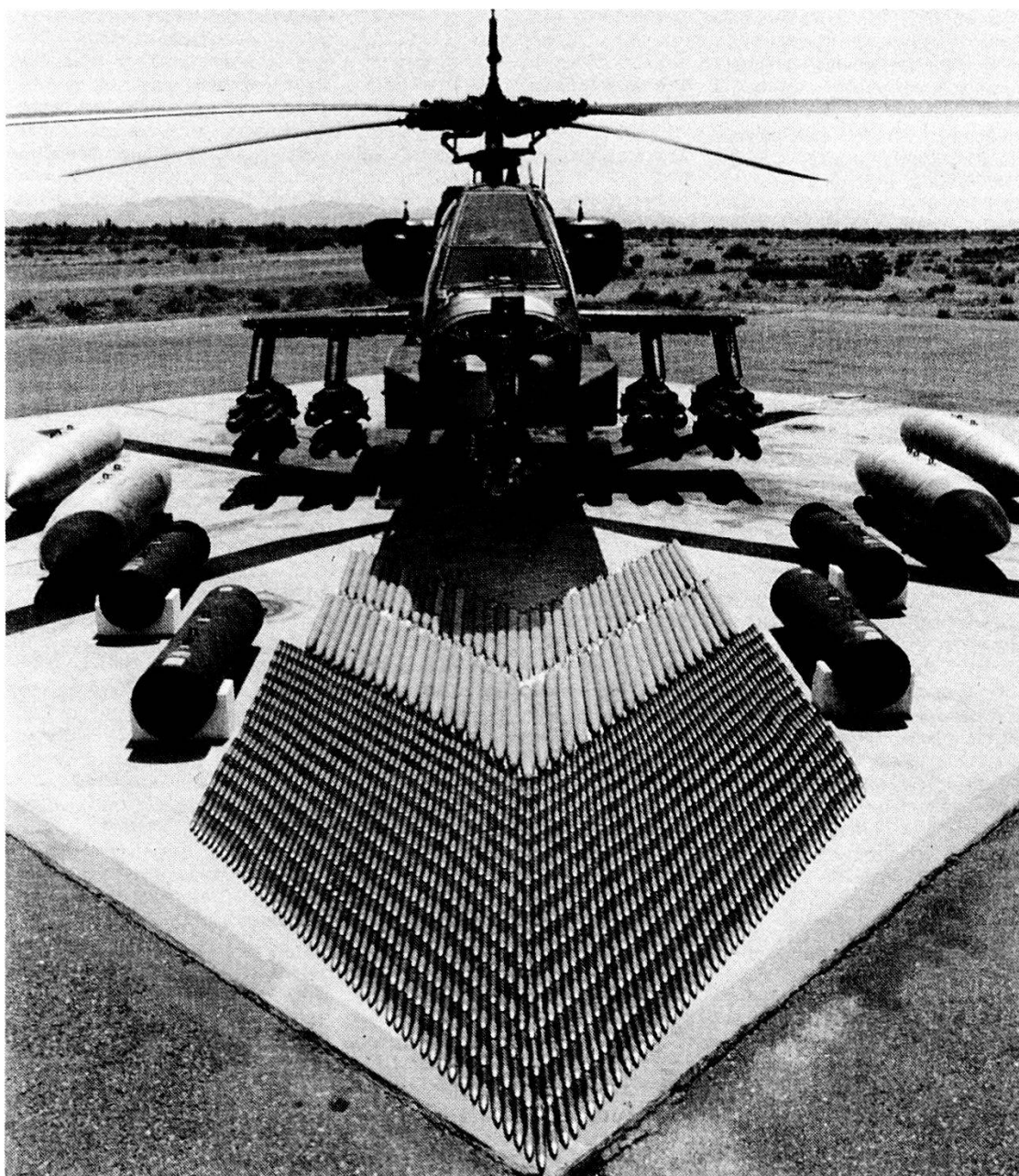
AH-64 Apache della Hughes USA. Armamento: 16 ordigni teleguidati Hellfire (sotto le ali); 76 razzi 2,75 inch; 1200 proiettili di cannone 30 mm. Apparecchio per la ricerca e l'attribuzione d'obiettivo, combinato con apparecchio per la direzione del tiro (giorno + notte), nel naso dell'elicottero.
