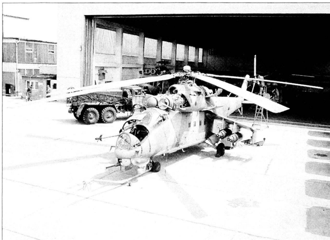
L'elicottero «Hind» è armato con 64 razzi da 57 mm, 4 missili controcarri AT6 e una mitragliatrice a 4 canne rotanti calibro 12,7 mm.
