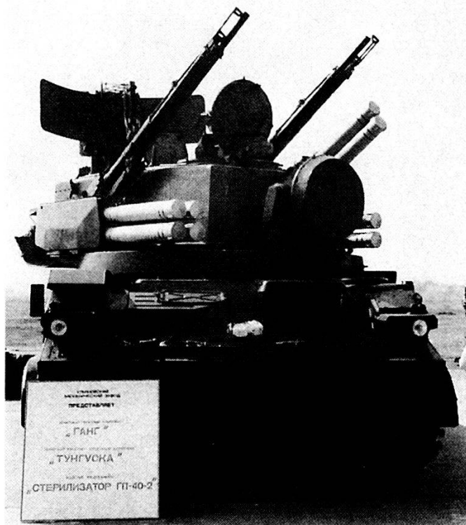
Il semovente controaerei binato/missilistico «Tunguska», concepito per sostituire lo ZSU-23-4, è armato con 2 cannoni da 30 mm ed 8 missili SA-19.
