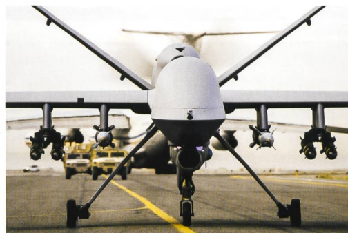
Il MQ-1 Predator è un aeromobile a pilotaggio remoto (APR), dotato della possibilità di impiegare 2 missili AGM-114 Hellfire.
