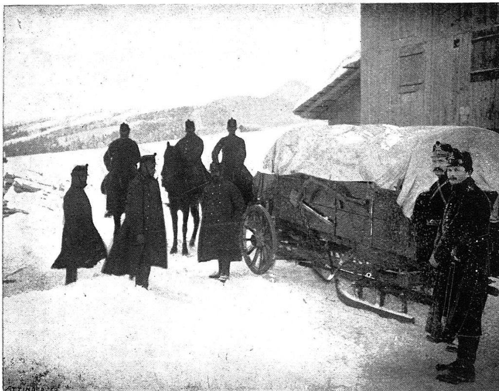
FIG. 10. — Fourgon de batterie, avec arrière-train sur luge.
