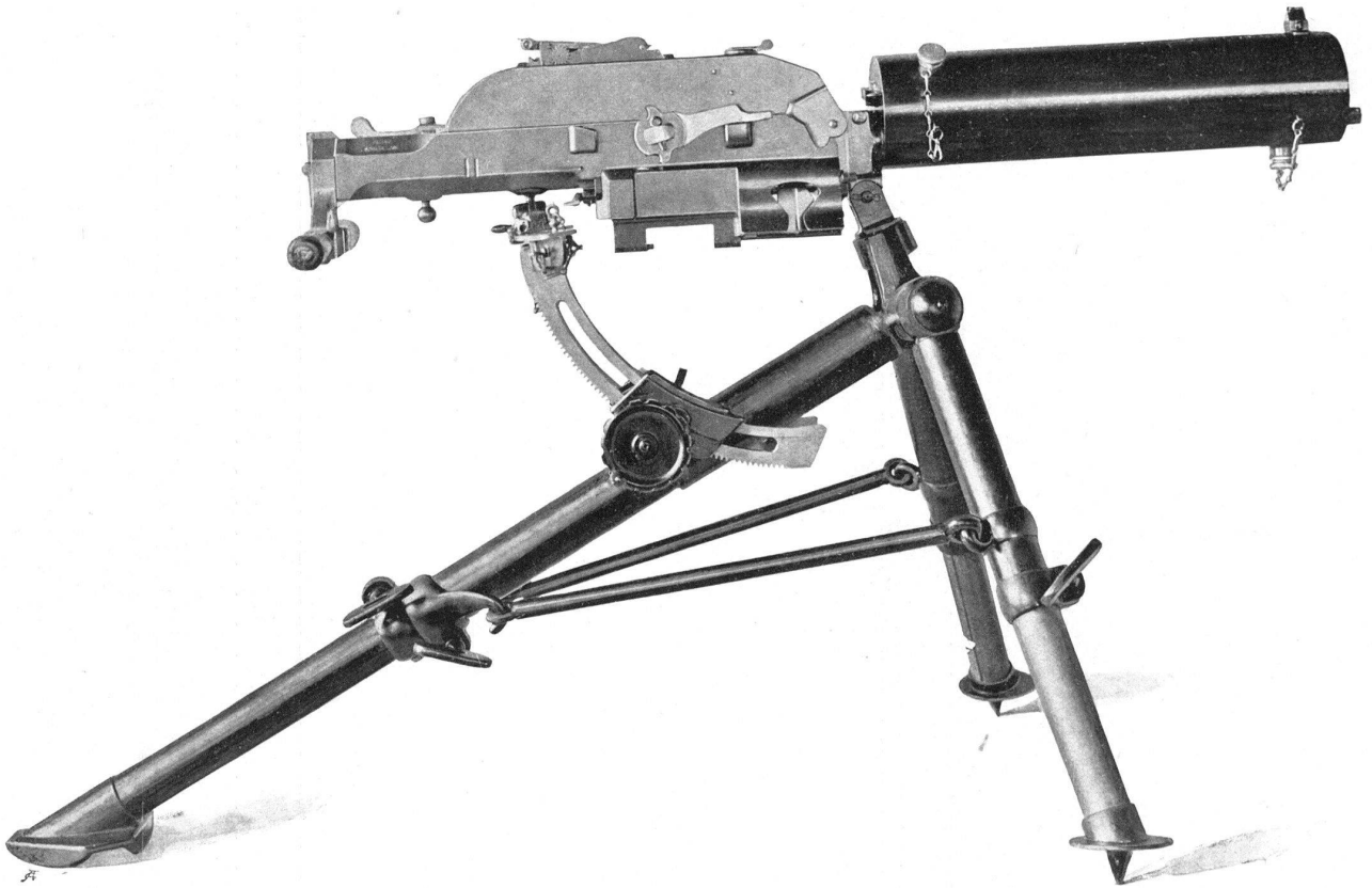
Mitrailleuse Schwarzlose, sur affût léger en forme de trépied, dans sa position de tir la plus élevée correspondant à une hauteur de tir de 60 cm. environ.
