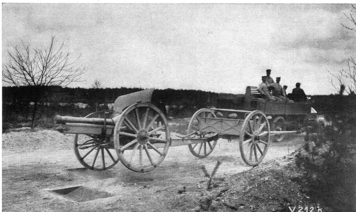
Fig. 8. — Caisson de campagne à recul sur l'affût franchissant des évidements pavés disposés alternativement sur la piste de Tangerhütte.
