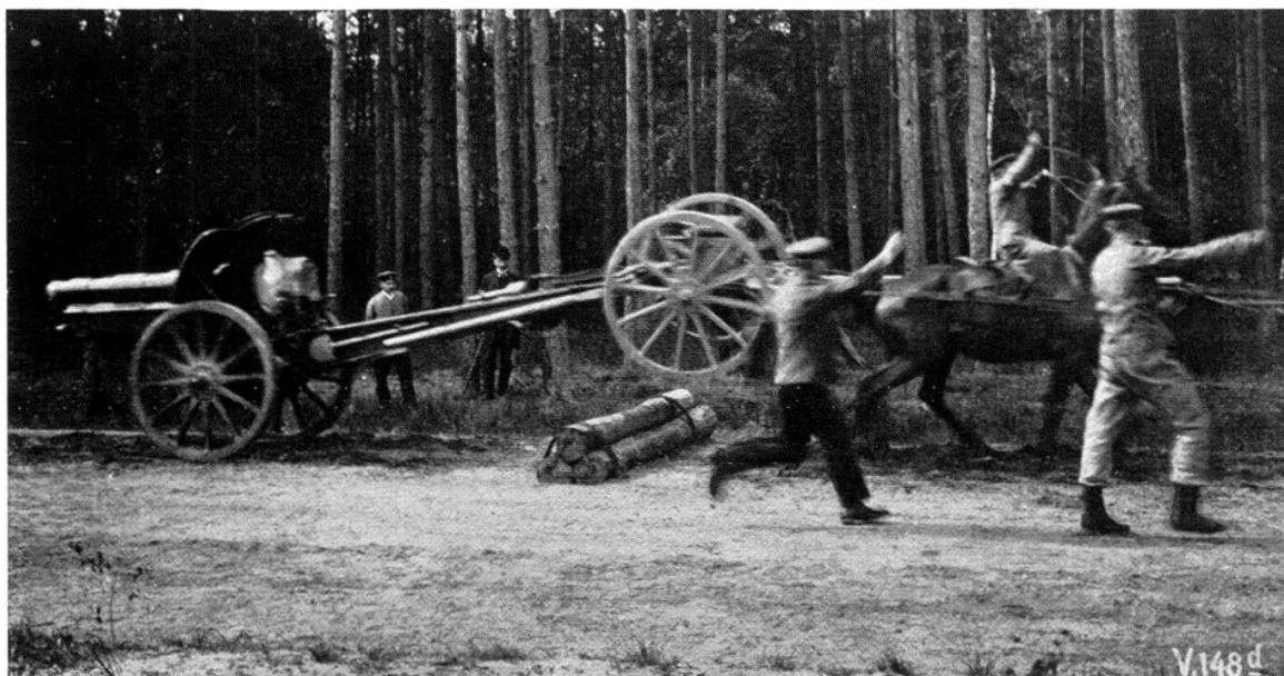
Fig. 5. — Canon de siège à recul sur l'affût trainé par des chevaux et franchissant un obstacle de bois au polygone de Tangerhütte. Passage de l'avant-train.
