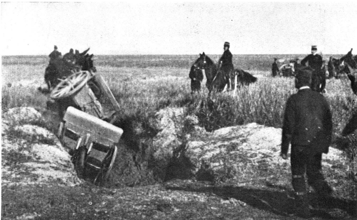
Fig. 2. — Canon de campagne Krupp, à recul sur l'affût, au passage d'un fossé profond pendant des essais de roulage en Italie.
