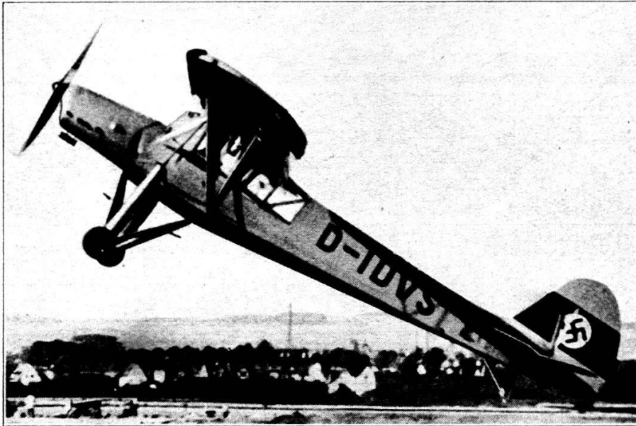
Décollage du Fieseler « F. 156 », avion le plus lent. Cet appareil décolle sur 40 m. et atterrit sur moins de 25 m.
