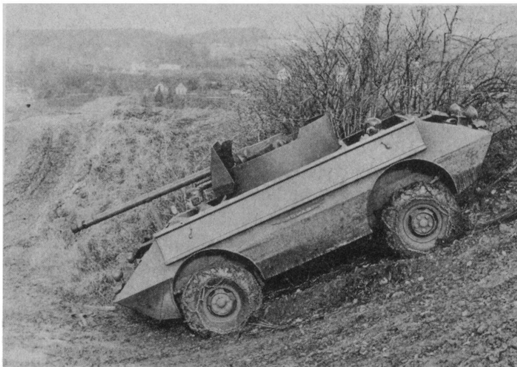
FIG. 2. — Véhicule antichars à double conduite. Direction des quatre roues. Canon 9 cm.
