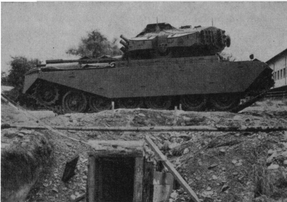
FIG. 7 a. — Essai de charge par le passage d'un blindé transversalement au tunnel.
