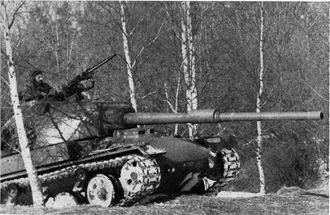
Malgré la grande inclinaison du bassin, le tube du canon peut être fortement baissé vers le sol, grâce à la silhouette un peu plus haute du char.
