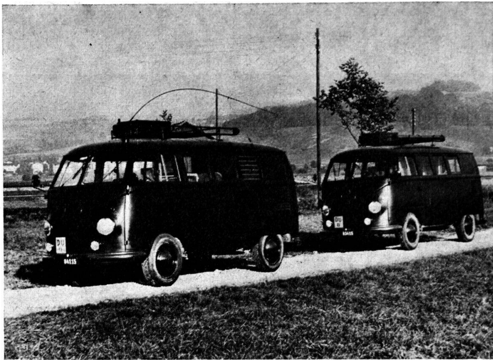
Le SE - 222, station radio à une voie téléimprimeur (à chiffage automatique) ou une voie téléphonique vue intérieure et aspect extérieur
