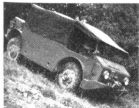
Véhicule d'artillerie Saurer-Berna à traction intégrale pour le transport de troupes et le remorquage, type 4MH, 1946.
