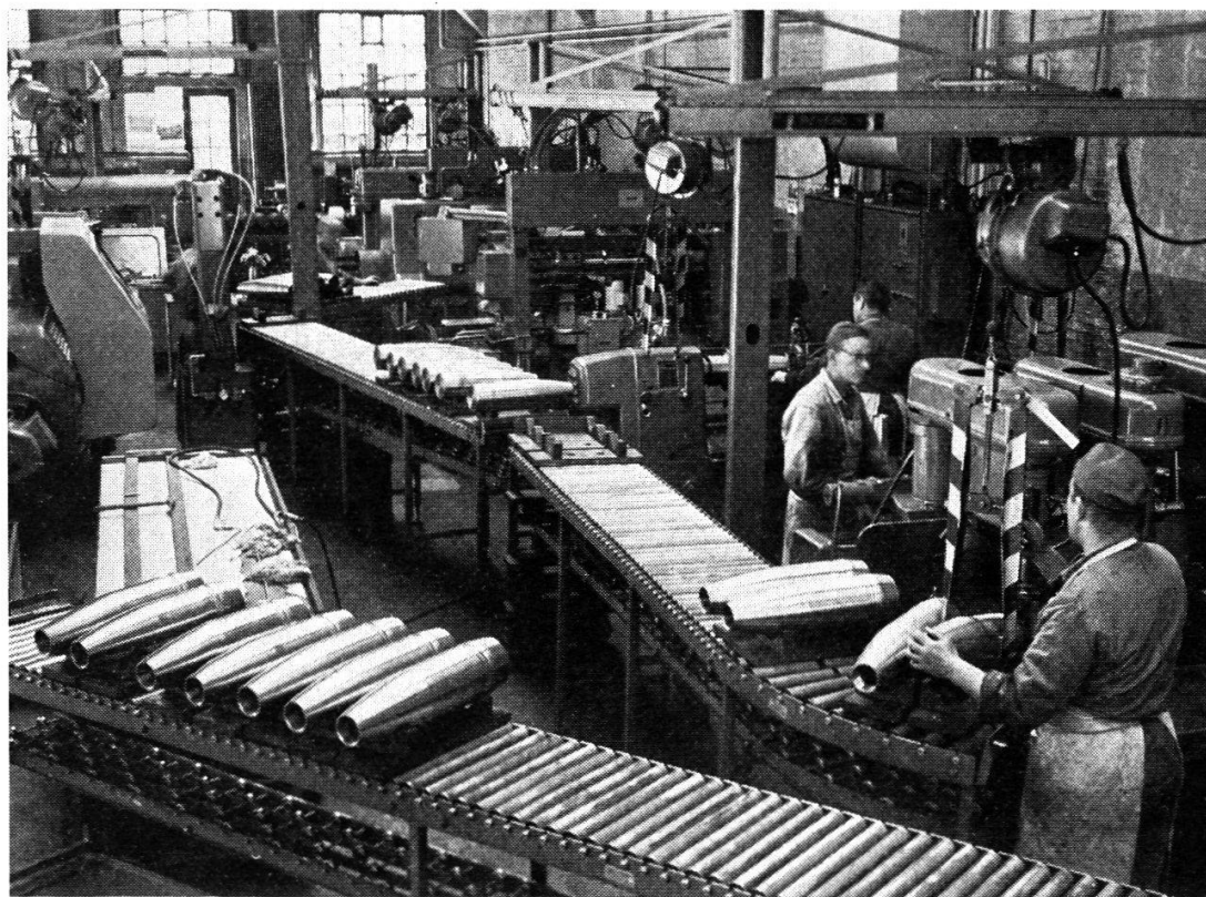
Fabrique de munitions Altdorf. Les corps des obus reçoivent leur forme définitive par des tours à copier modernes.
