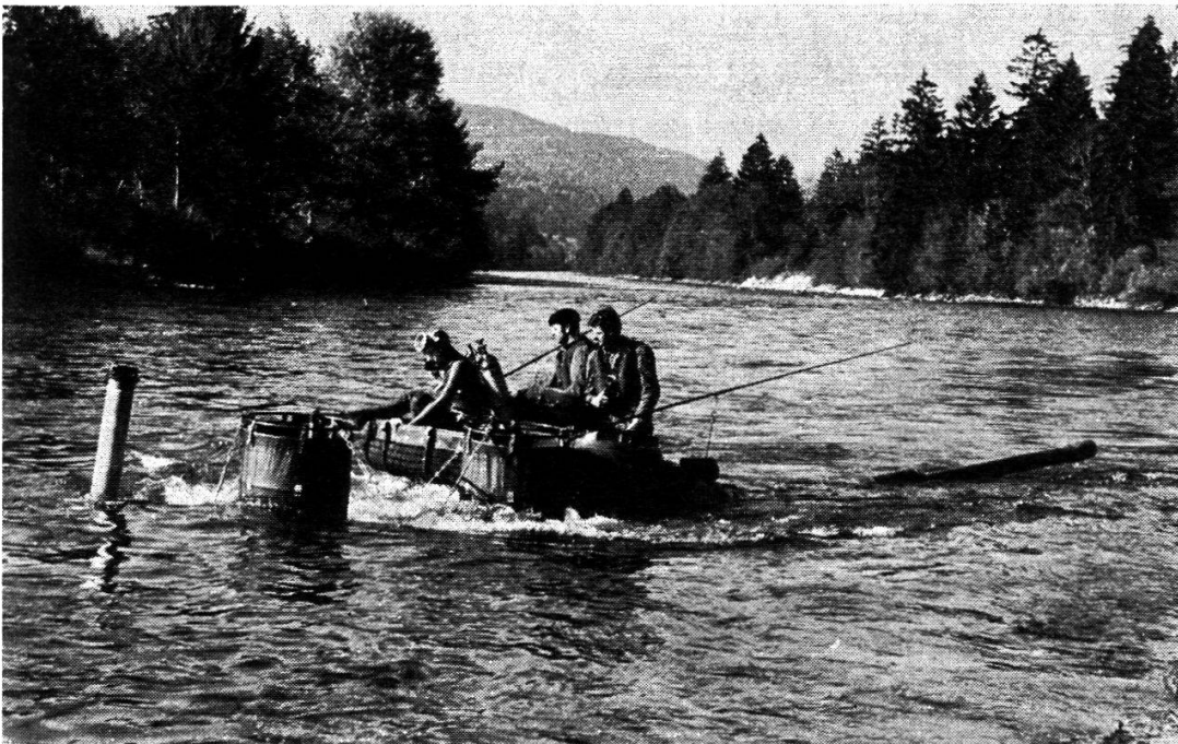
Essai de passage à gué profond avec le char 68.
