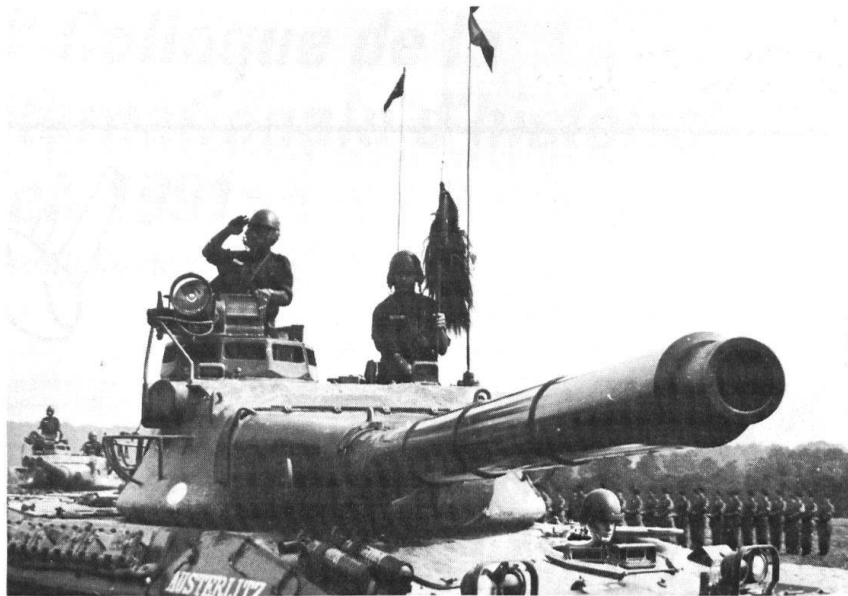
Sur cet AMX-30, qui reste encore aujourd'hui le char de combat des formations mécanisées françaises, on distingue la pièce principale, ainsi qu'à gauche, le système de visée du pointeur (le couvercle blindé est ouvert).
