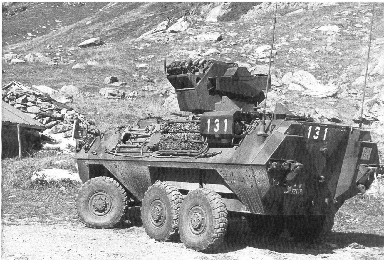
Tir terminé! Le chasseur quitte sa position. Sur cette vue de trois quarts, on remarque l'outillage, le groupe électrogène, et les lance-pots fumigènes sur l'arrière de la tourelle
