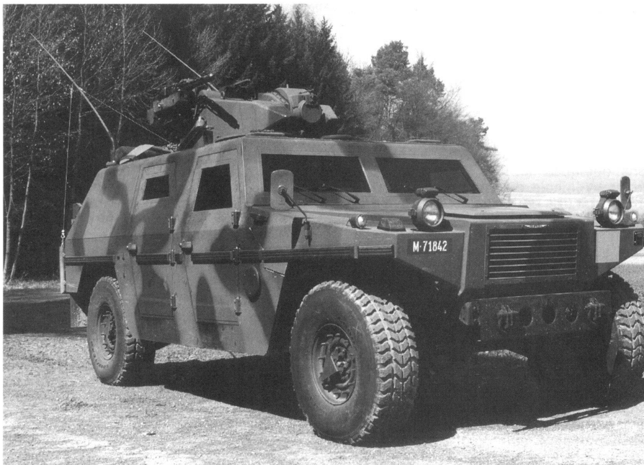
Le Véhicule d'Exploration 93, vue de face du prototype. Nettement visible, le tourelleau avec l'appareil de vision thermique, protégé par un couvercle manœuvré depuis l'intérieur du véhicule. La vitre latérale du copilote a été agrandie pour donner un meilleur angle de vision au pilote. Ce véhicule est équipé d'un système de régulation de la pression des pneus, qui ne sera pas repris sur le véhicule de série. [Photo Mowag]
