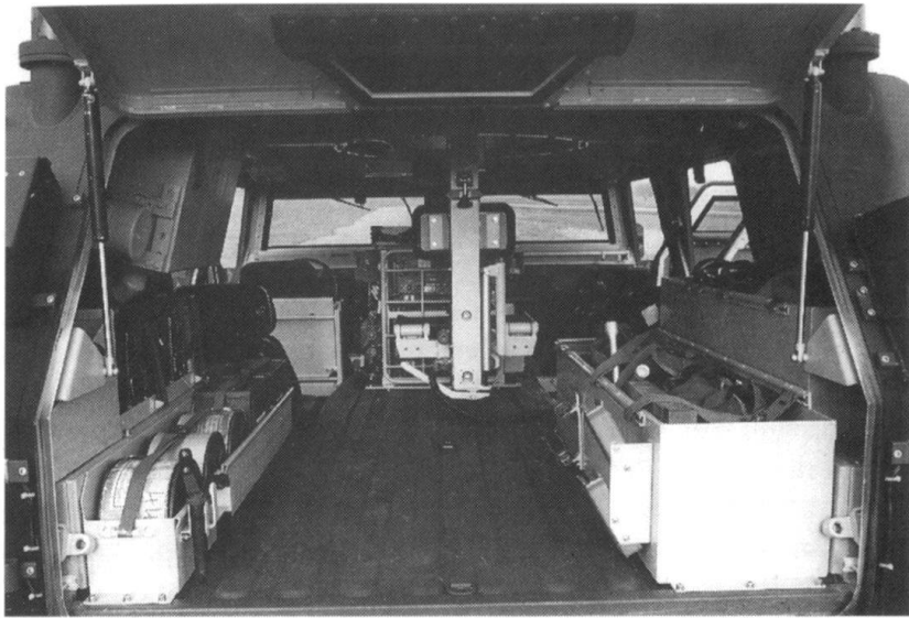
Vue de l'intérieur du véhicule. A gauche, les bobines de fil pour les liaisons téléphoniques et la munition. A droite, l'outillage de bord. Au centre, le support du siège de l'observateur qui peut être tourné de manière à dégager l'espace suffisant pour une civière. [Photo Mowag]
