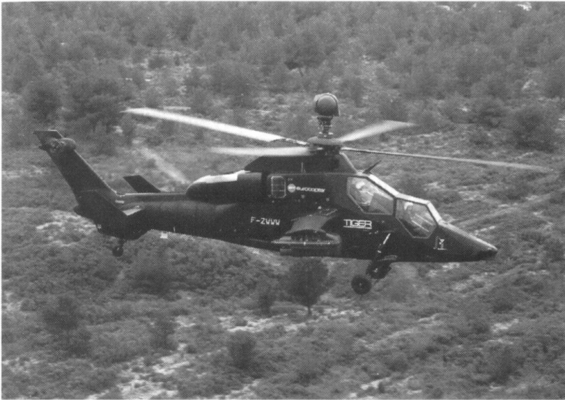
Le Tigre avec son armement de base (8 missiles antichars et 2 missiles air-air), présenté ici avec son viseur de mât, au-dessus du rotor principal (Photo Eurocopter).
