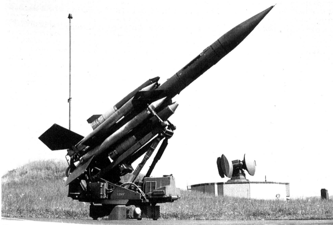
Un engin guidé BL-64 sur sa rampe de lancement. A l'arrière-plan, les radars de détection et de poursuite.
