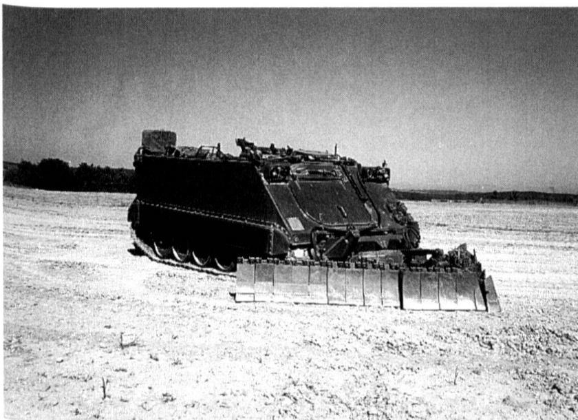
Char de grenadiers équipé de la charrue de déminage légère (Essais été 1995).
