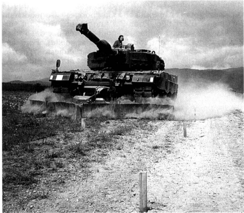
Char de combat Léopard équipé de la charrue de déminage légère (Essais été 1995).
