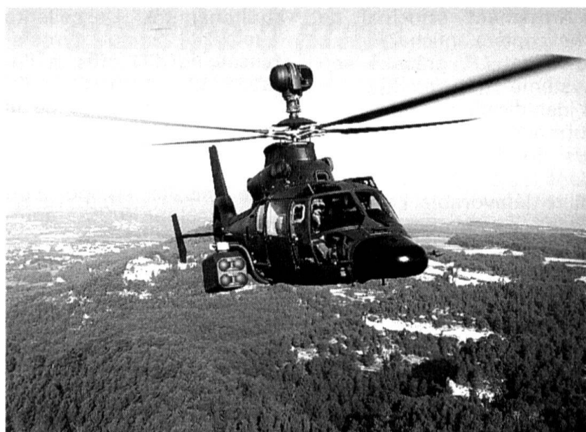
Le Trigat LP, monté sur un Panther pour effectuer les essais en vol. (Photo Aérospatiale / E. Raz).
