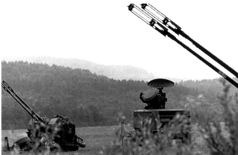
Une unité de feu 35 mm, soit 4 canons de 35 mm, 1 appareil de conduite de tir Skyguard.
