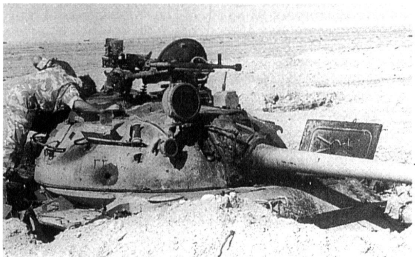
Char irakien détruit par un obus-flèche britannique lors d'un engagement nocturne entre 1000 et 2000 mètres. Son projecteur IR ne permettait pas à son équipage de voir aussi loin que son adversaire équipé d'une caméra à thermovision.
