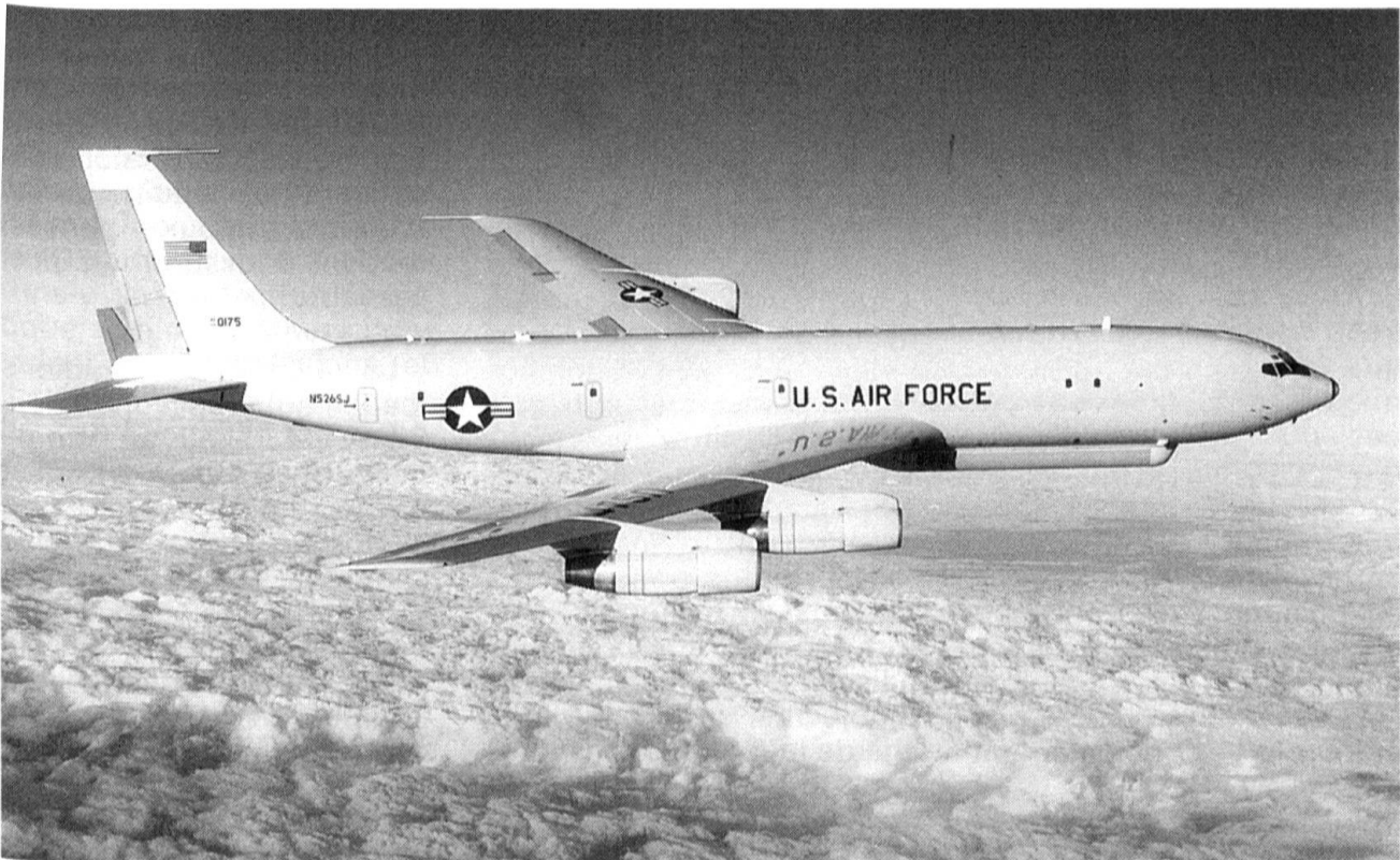
La maîtrise du champ de bataille passe par la maîtrise de l'information. L'E-8C de Northrop Grumman emporte le système radar Joint Stars (Photo : Northrop Grumman).
