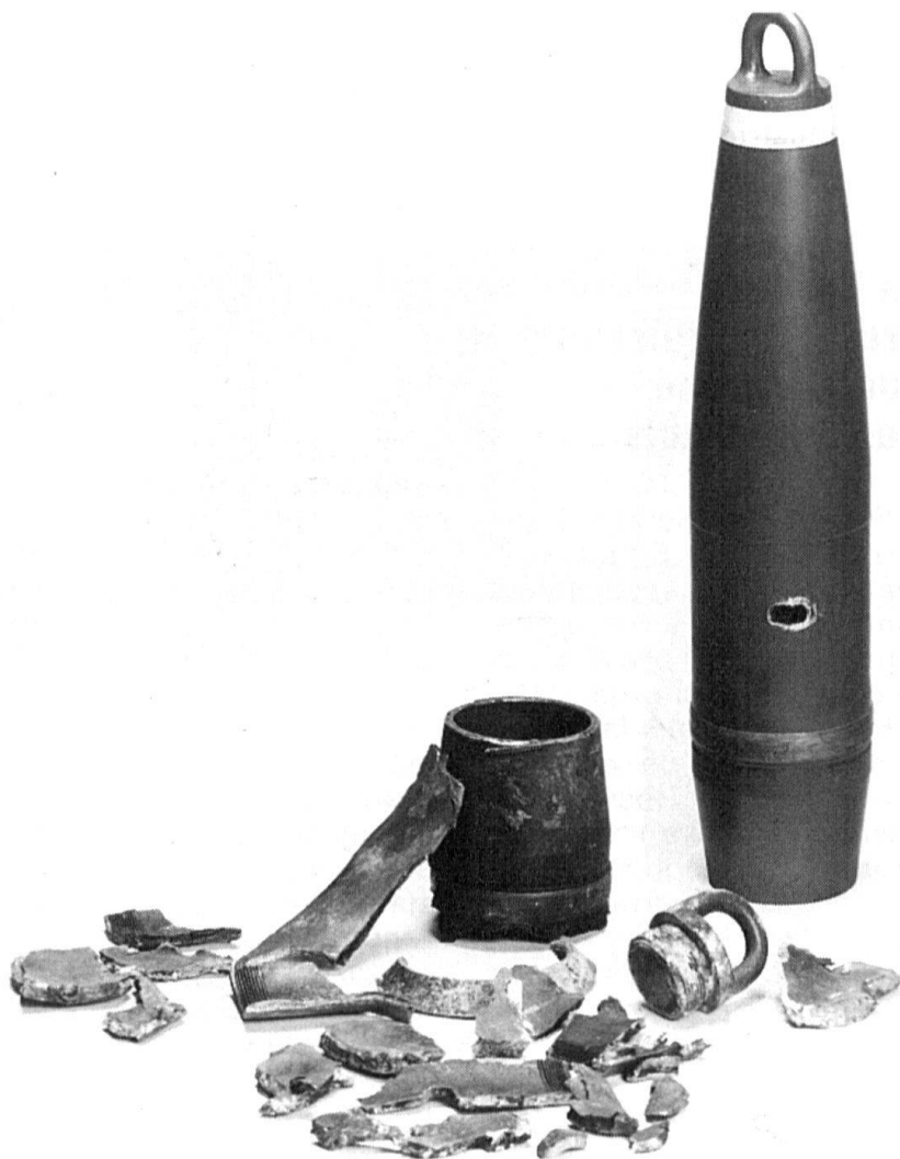
Créer un environnement plus sûr : les munitions muratisées résistent aux impacts de projectiles (à droite), contrairement aux munitions standards (Photo : Club Murat).
