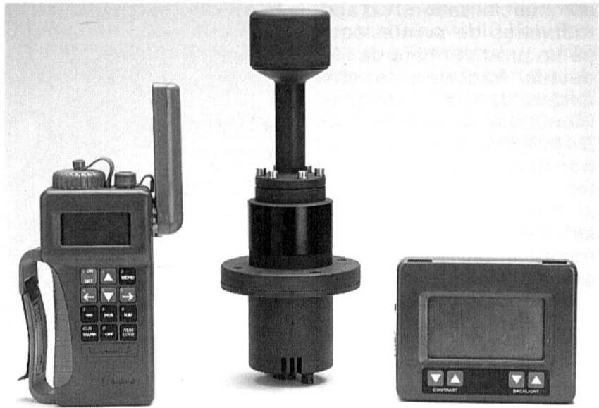
Le module ANAV de navigation par GPS de Leica (Photo : Leica).
