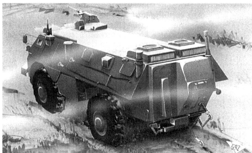
Vue d'artiste de la maquette (année 1992) du VAB RECO NBC, véhicule de l'avant blindé de reconnaissance NBC. Engin équipé pour pénétrer dans des zones contaminées, détecter et donner l'alerte NBC. (Photo : DGAS/ET CA/CEB).
