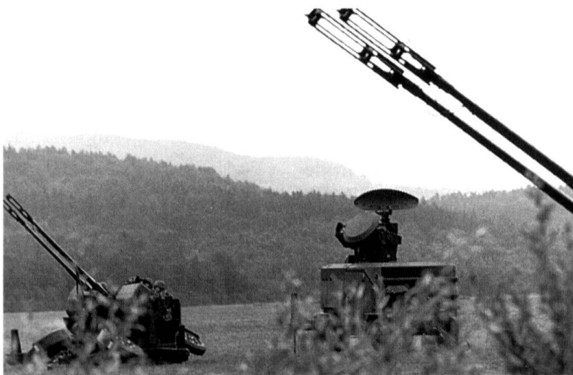
Une unité de feu 35 mm, soit 4 canons de 35 mm, 1 appareil de conduite de tir Skyguard.
