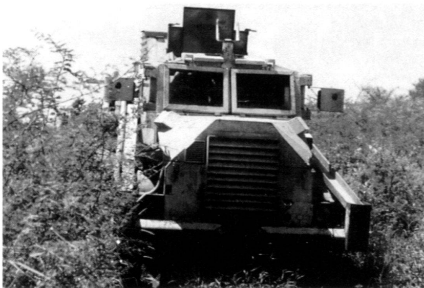
Mannschafts-Transportfahrzeug «Casspir», gepanzert und minengeschützt.
