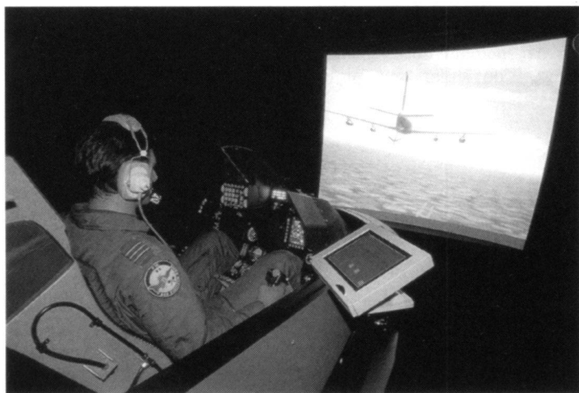
Les drones de combat peuvent être commandés depuis des consoles ressemblant à des simulateurs de vol (ici, le Flight Sim F-16 de Kleine Brogel). Le pilote se trouve à des milliers de kilomètres de son appareil. Toutes les données concernant l'environnement (vue extérieure, image radar,...) sont relayés par satellite.
