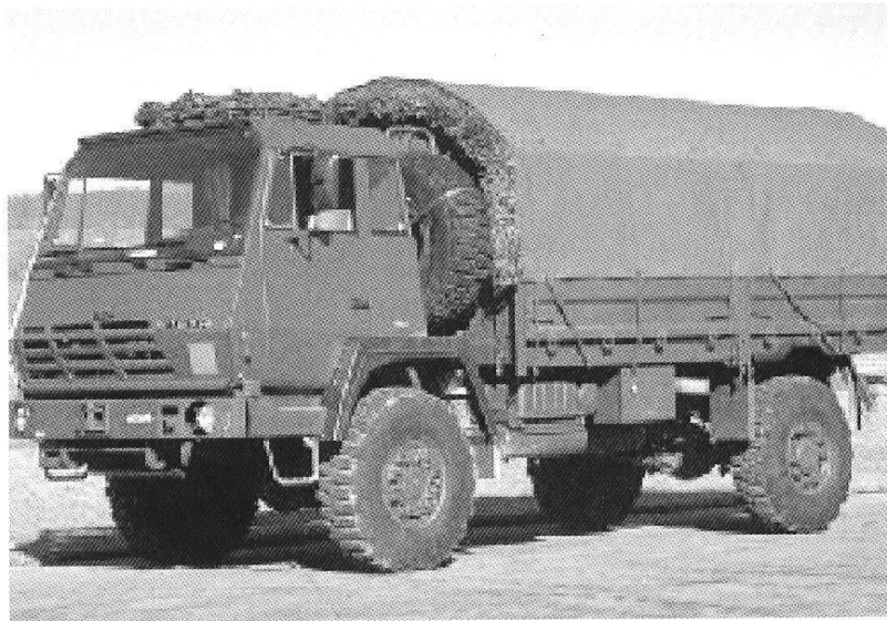
Camion 5,6 t tout terrain 4x4 Steyr : ce type de véhicule est appelé à devenir le véhicule standard de l'armée XXI.
