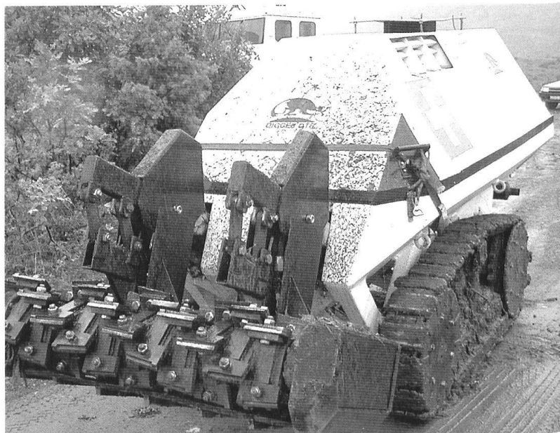
L'outil de défrichage de la Digger-1.
