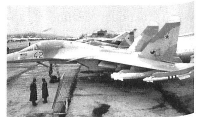
Su-32: ce bombardier tactique emporte 8 tonnes de charges externes.
