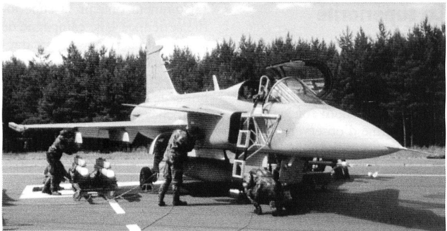
Le Gripen, qui peut opérer à partir de bases avancées: le temps nécessaire au Turn-around ne dépasse pas dix minutes.
