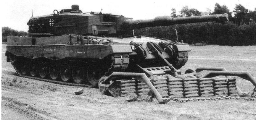
Lame de déminage Amir sur châssis du Leopard 2 (Mak).
