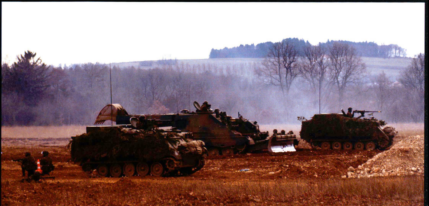
Protégé par une section de sapeurs de chars transportés en M-113, le char du Génie déblaie l'obstacle et permet le franchissement des chars de combat.
